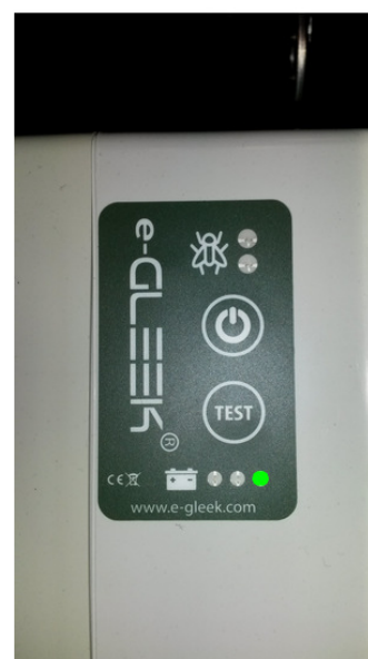
e) 2 appuis successifs sur TEST vont initier le hot spot Wifi (diode batterie clignotante) SSID: e-gleekxxxxxx Mot-de-passe: tgv44air!
