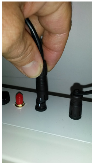
a) Connectez le tube optique au calculateur
