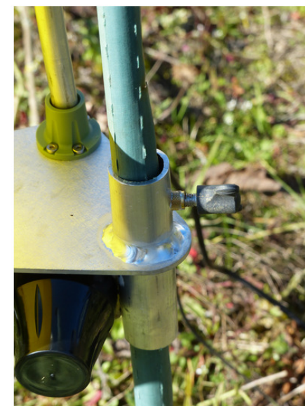
e) Un piquet diam. 16mm peut être utilisé pour adapter la hauteur du piège.
