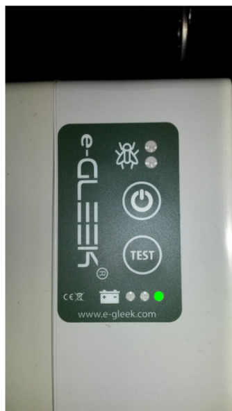
d) Un appui sur TEST indique la tension de batterie
