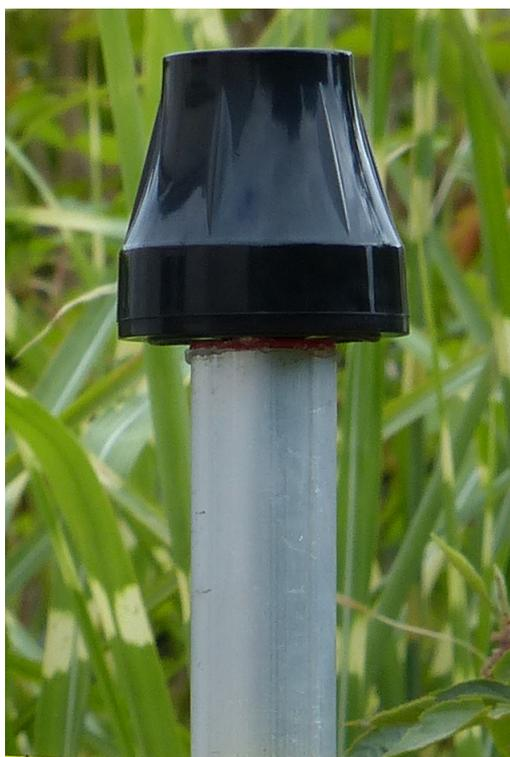
Figure 9: Antenne du piège e-Gleek
