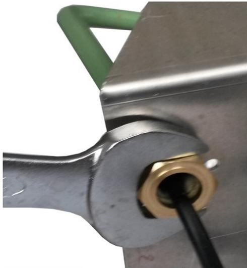
Figure 6: Serrage de l'écrou (clé plate de 19)
