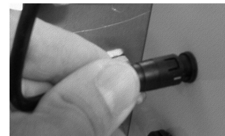
g) Connecter le câble de la caméra au connecteur 4 points de la boîte grise.
